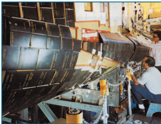
Jednu z největších technických výzev u raketoplánu představovala vícenásobně použitelná tepelná ochrana.
