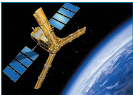
8. Evropská družice SMOS (Soil Moisture and Ocean Salinity) provádí mj. měření vlhkosti půdy a slanosti vody v oceánech.
