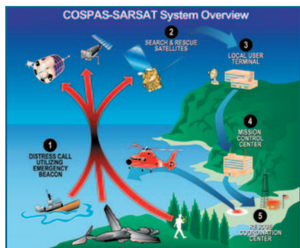
13. Schéma záchranného kosmického systému SARSAT-KOSPAS.
